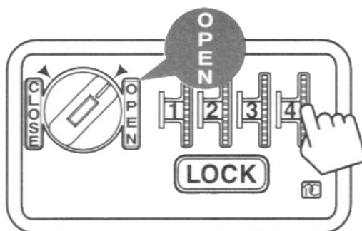
(3) ツマミをCLOSEへ回してLOCKボタンを押して下さい。ダイヤルが
