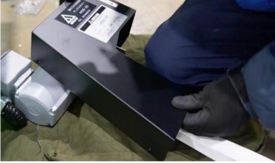
カバーを取り外す<br>側面のボルトを2ヵ所外し、カバーを取り外します。                                                                                                   | 六角レンチ |                                |
