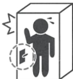
大型のボックスの内部には緊急脱出用レバーが備え付けられています。ボックス内に閉じ込められたときは、緊急脱出用レバーを押下げると扉が開きます。
