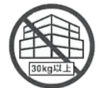
重量が30kgを超えるものは入れないでください。棚が変形、破損する原因になります。
